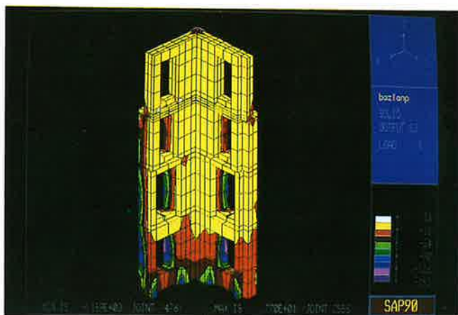
FIGURA 10: COMPRESIONES EN LAS CARAS INTERNAS DE LOS MUROS DE FACHADA CON ADORNOS DE SILLERIA, SUELO RIGIDO. Obsérvense, sobre todo en el arranque, las concentraciones de tensiones bajo las esquinas de los huecos. FIGURE 10: COMPRESSION IN INTERNAL FACES OF FACING WALLS WITH ASHLARS ORNAMENTS. Note the stress concentrations, especially at the base, below the corners of openings.
