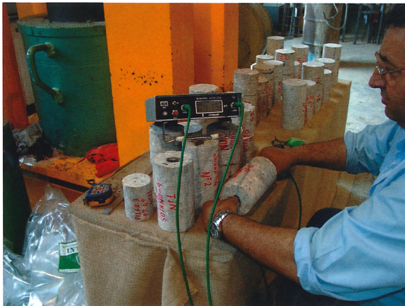
Figura 28. Ensayo por ultrasonidos de muestras obtenidas de los testigos Figure 28. Ultrasonic testing of sections of core samples
