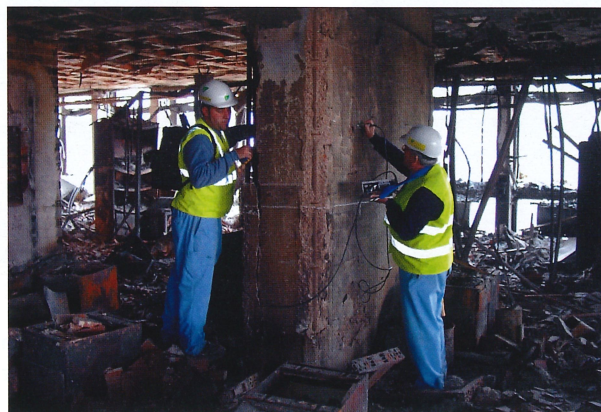
Figura 23. Auscultación por ultrasonidos Figure 23. Ultrasonic testing
