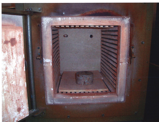
Figura 27. Tratamiento en horno de muestras de hormigón Figure 27. Thermal treatment of concrete samples
