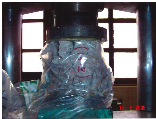
Figura 26. Ensayo a compresión de muestras de hormigón Figure 26. Compression test on concrete samples
