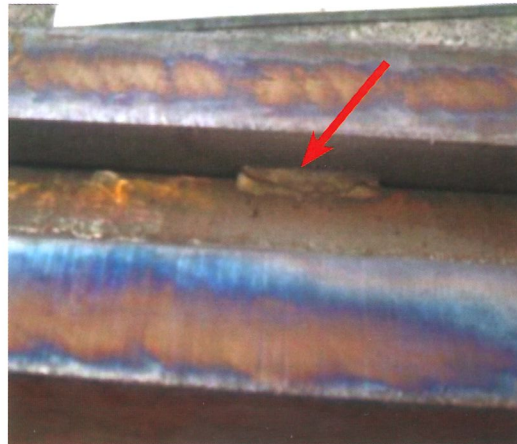
Figure 19b. Provisional weld crack Figura 19b Fisura en soldadura provisional
