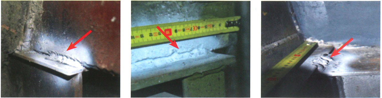
Figura 16. Defecto de mordedura. Ensayos por partículas magnéticas Figure 16. Undercuts. Magnetic particle tests
