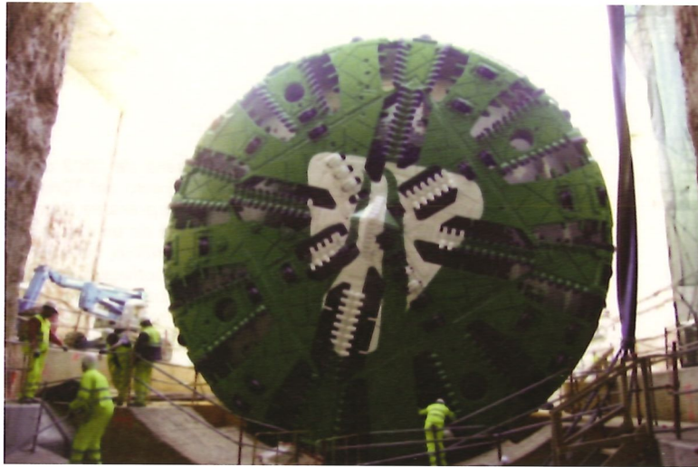
Figure 1: Earth pressure balance shield cutterhead Figura 1: Escudo de Presión de tierras. Vista de la cabeza de corte
