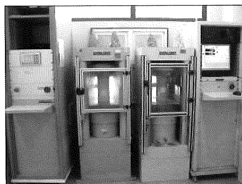
Fotografía nº 3: Prensas de rotura de probetas, de 3000 kN de capacidad
