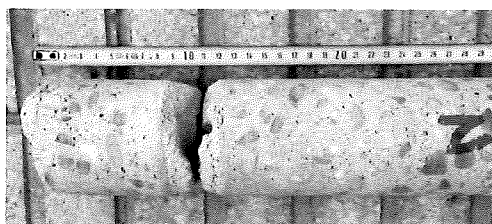
Photographs 3, 4, 5 and 6. Core drilling to determine the quality of the concrete in the pile Fotografías n° 3,4,5 y 6. Extracción de probetas testigo para determinar la calidad del hormigón del pilote.
