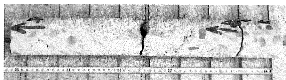
Photographs 3, 4, 5 and 6. Core drilling to determine the quality of the concrete in the pile Fotografías n° 3,4,5 y 6. Extracción de probetas testigo para determinar la calidad del hormigón del pilote.
