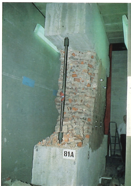
Foto 4. Ensayo a compresión a escala real de la fábrica de la Torre colapsada (Departamento de Mecánica Estructural, Pavia).
