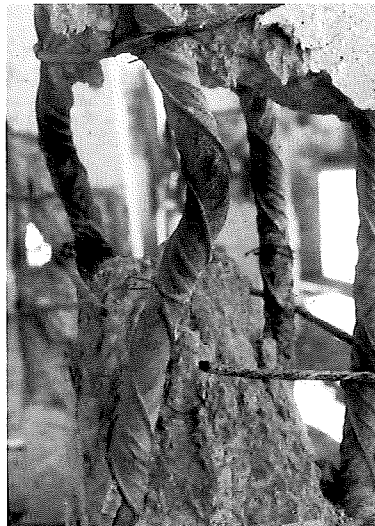
Figura 4 Influencia de la armadura transversal en pilares con fuerte cuantía de armadura (Ensayos de INTEMAC, 1972) (6)
