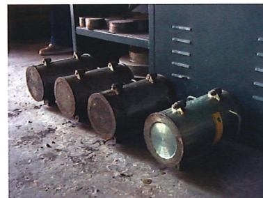
Forma de colocación de las probetas para llevar a cabo el refrentado Specimen laying for capping Fig. 5
