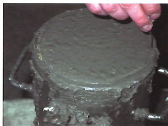
Proceso de retirar los papeles no adherentes y limpieza de los orificios para permitir el ensamblaje de la tapa del molde
