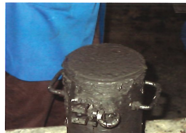
Reposo de la probeta por un período de 30 minutos Specimen settling for 30 minutes
