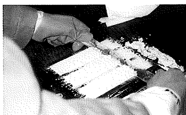
Fabricación probetas mortero Manufacture of mortar specimens Fig. 29
