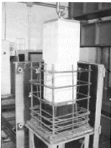
Fotografía 2. Detalle del pilar en molde y de la ferralla del refuerzo Photograph 2. Detail of column in mould and reinforcing steel
