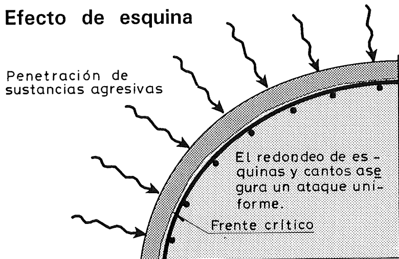
Fig. 12. Las esquinas y cantos redondeados o poligonales distribuyen y reducen el ataque en estas zonas.
