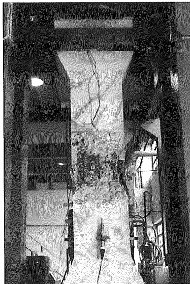
Fig. 2. Rotura de un pilar reforzado
