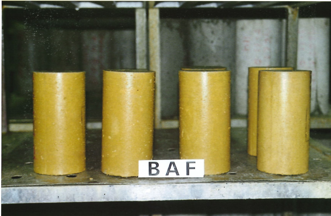
Fotografía n° 3. Exposición en cámara húmeda estándar (hormigón con cemento blanco, pigmento amarillo y consistencia fluida). Photo No. 3. Storage in standard humid room (flowing white concrete with yellow pigment).
