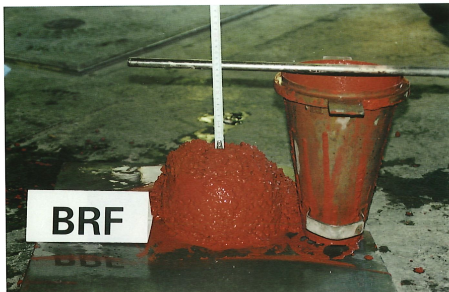
Fotografía nº 6. Medida de la consistencia (hormigón con cemento blanco y pigmento rojo). Photo No. 6. Slump measurement (white concrete with red pigment).
