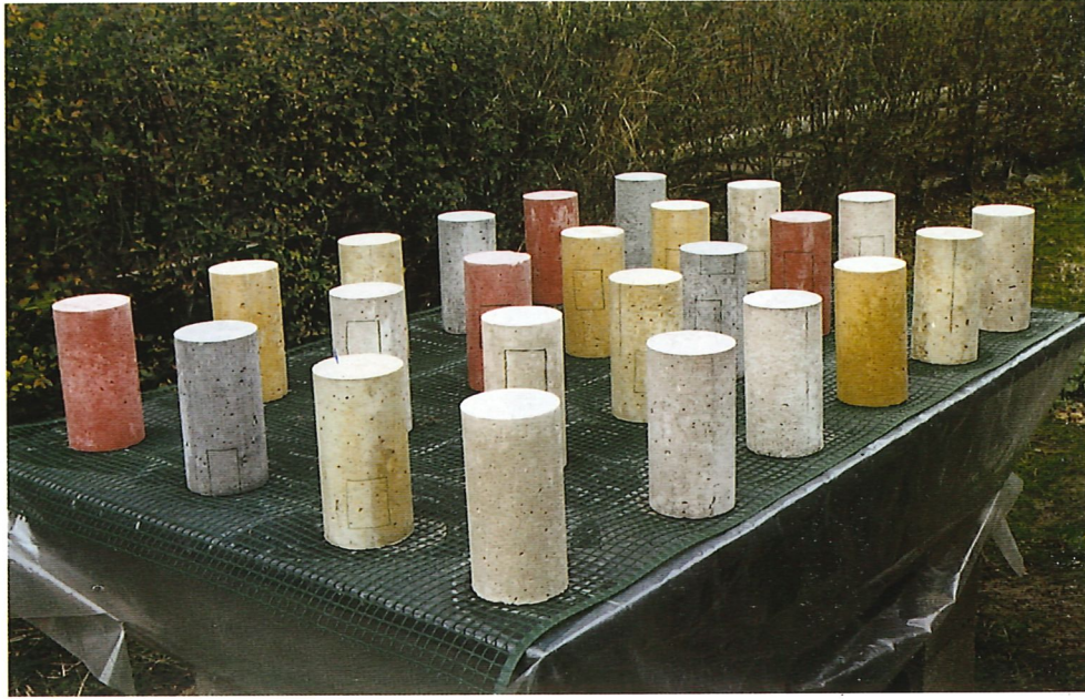
Fotografía nº 1. Exposición a la intemperie. Photo No. 1. Exposure to outdoor weathering.
