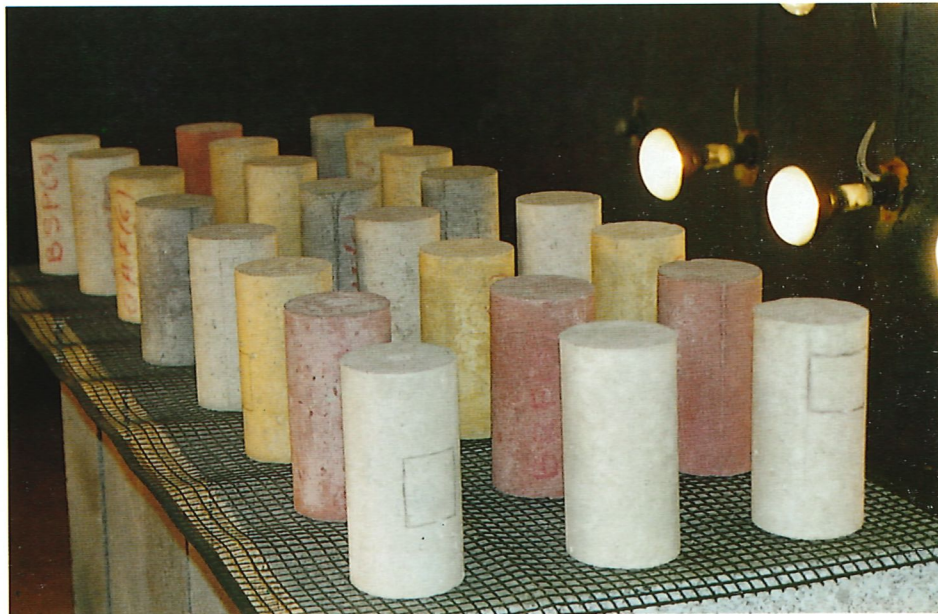
Fotografía nº 2. Exposición a ciclos de humedad y secado. Photo No. 2. Exposure to wetting-drying cycles.
