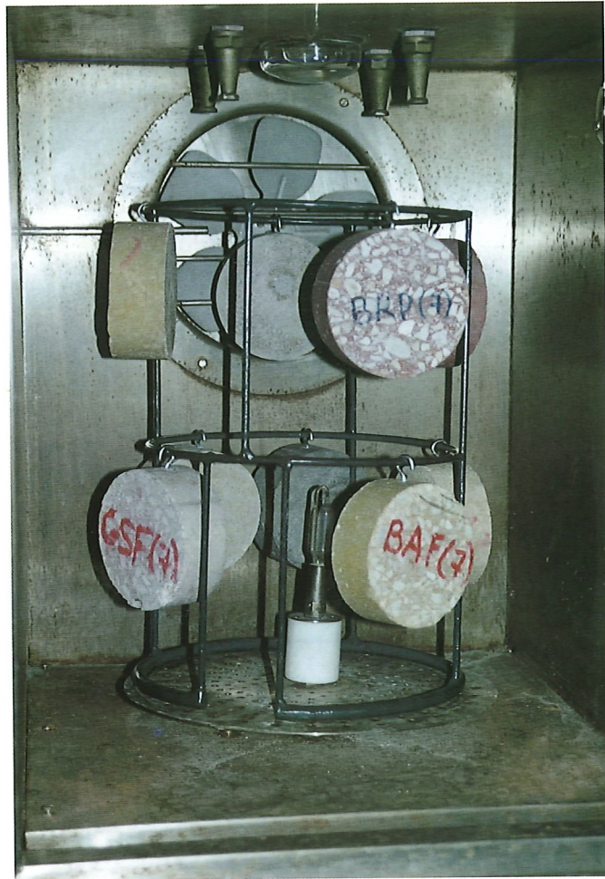
Fotografía nº 5. Exposición a radiación ultravioleta en cámara de envejecimiento artificial acelerado. Photo No. 5. Exposure to ultraviolet radiation in accelerated weathering chamber.
