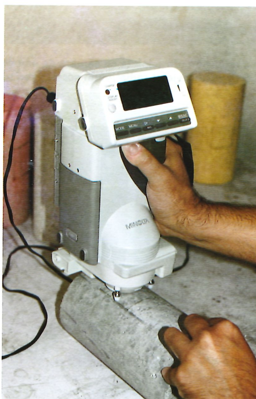
Fotografía nº 8. Procedimiento de medida de la coordenadas cromáticas L^* , a^* , b^* , mediante el empleo del espectrofotómetro. Photo No. 8. Spectrophotometric procedures to measure colour co-ordinates L^* , a^* , b^* .
