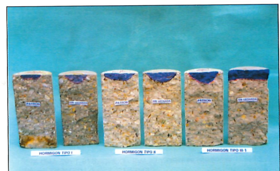
Permeabilidad en hormigones sin lechada (respecto al patrón). Permeability test on concrete without cement paste layer (related to standard concretes).
