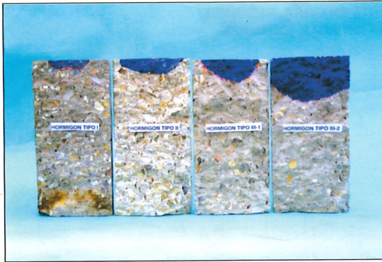
Permeabilidad en hormigones patrón (sin defectos). Permeability test on standard concrete (without defects).
