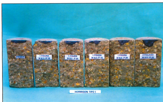
Permeabilidad en hormigón tipo I con fisuras. Permeability test on type I cracked concrete.
