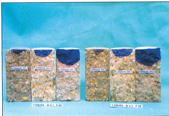
Permeabilidad en hormigones con fisuras. Permeability test on cracked concrete.
