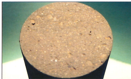
Superficie de acabado sin lechada. Finishing surface without cement paste layer.
