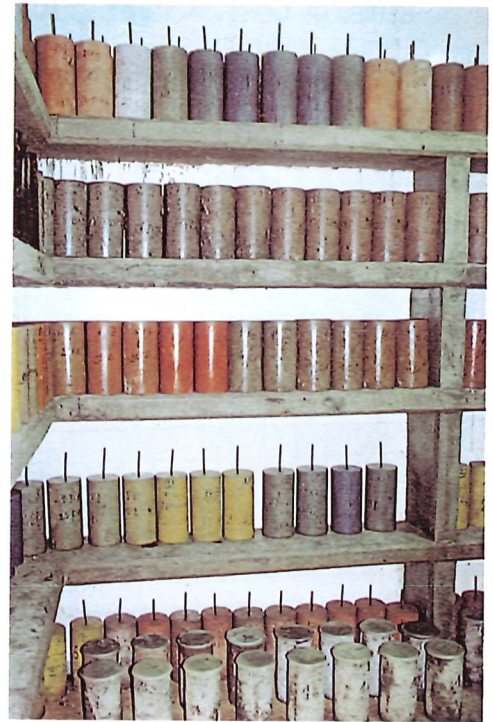
Probetas en la cámara húmeda. Con el 100 % de humedad no aparecen eflorescencias.
