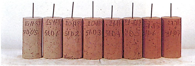
Hormigón con 350 Kg de cemento/m 3 - cemento Gris PA-350. Pigmento Rojo BAYER 130: 0,5 %, 1 %, 2 %, 3 %, 4 %, 5 %, 6 %, 7 %.
