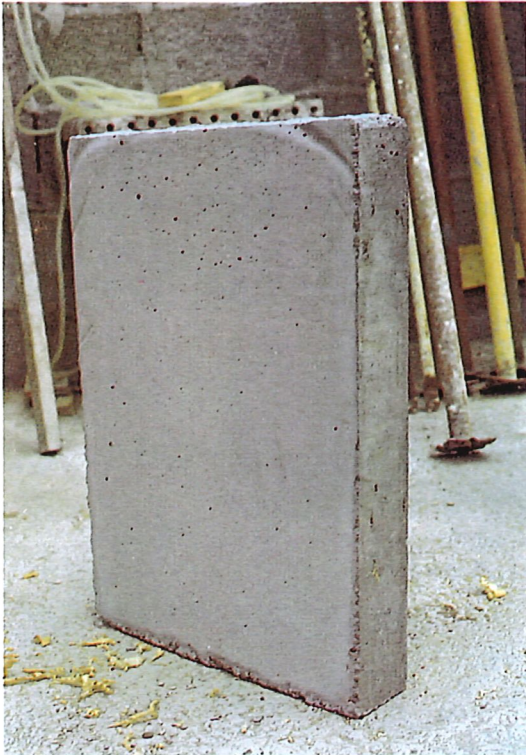
Encofrado con lámina de Polietileno. Formwork with polythene sheeting.
