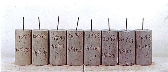
Hormigón con 300 Kg cemento/m 3 - cemento Gris PA-350. Pigmento Bayer Azul Luz 100: 0,5 %, 1 %, 2 %, 3 %, 4 %, 6 %, 7 %.
