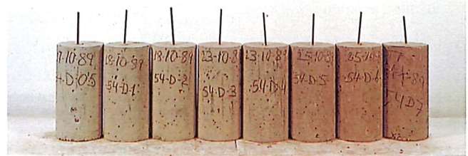
Hormigón con 350 Kg de cemento/m 3 - cemento Gris PA-350. Pigmento Tierra Natural: 0,5 %, 1 %, 2 %, 3 %, 4 %, 5 %, 6 %, 7 %.
