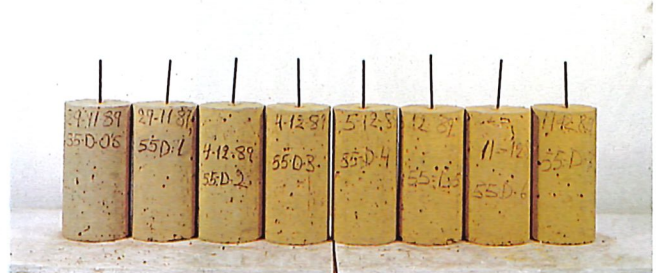
Hormigón con 350 Kg cemento/m 3 - cemento Gris PA-350. Pigmento Bayer Amarillo 930: 0,5 %, 1 %, 2 %, 3 %, 4 %, 5 %, 6 %, 7 %.
