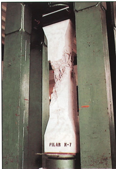
Fotografía nº 15. Aspecto de la rotura de un pilar patrón. (Pilar nº 7).
