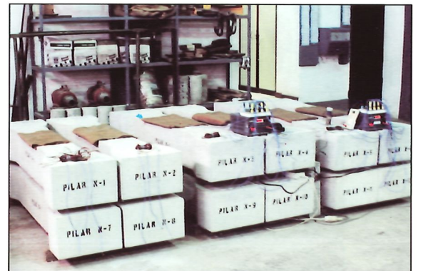
Fotografía nº 10. Pilares sometidos al proceso de corrosión acelerada. Photograph No. 10. Columns subjected to accelerated corrosion.
