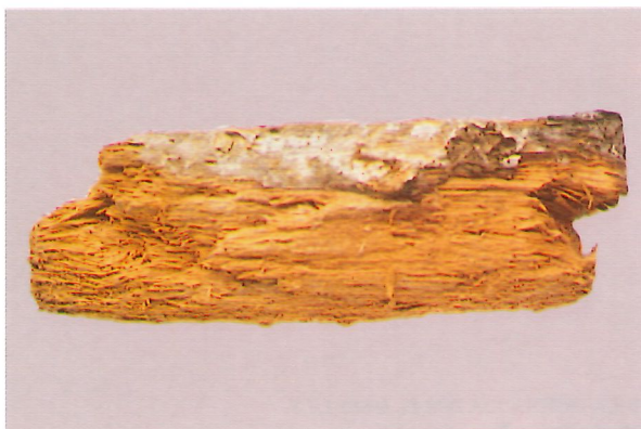
6. DETALLE DE MADERA ATACADA CON PUDRICIÓN FIBROSA ( DONKIOPORIA ). 6. DETAIL OF WOOD ATTACKED BY THE DONKIOPORIA .
