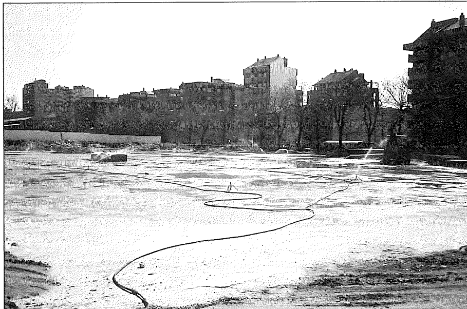
Fotografía 7. Pruebas de estanqueidad al agua en cubierta. Photograph 7. Water penetration testing in roofs.
