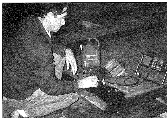
FOTO 5. ENSAYO DE ULTRASONIDOS PHOTO 5. ULTRASONIC TESTING
